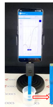
図 6. 市販小型ポテンシostatを用いた場合の測定系
